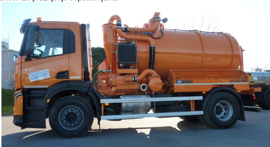
Slika 2: Kamion za pražnjenje septičkih jama
